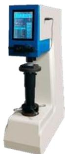
Рисунок 4. Общий вид твердомеров ИТБ-3000-I-АС
