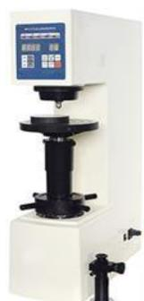
Рисунок 10. Общий вид твердомеров ИТБ-3000-II-АЖ
