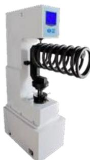
Рисунок 11. Общий вид твердомеров ИТБ-3000-II-АЖД
