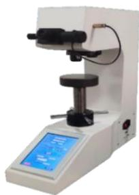
Рисунок 1. Общий вид твердомеров ИТБ-62,5-I-АС
