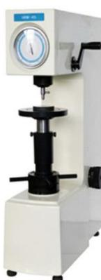
Рисунок 4. Общий вид твердомеров
