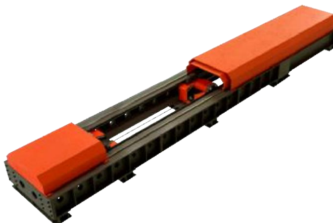
Рисунок 4 – Общий вид машины испытательной универсальной РГМ-I с гидравлическими захватами 4-х колонная
