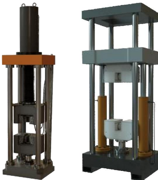
Рисунок 4 – Общий вид машины испытательной универсальной РГМ-I с гидравлическими захватами 4-х колонная
