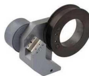
Пневмозахваты «Улитка» ПУП-20, ПУП-50 для нитей, шнуров, лент и пр. 22 мм (0 10 мм), 20 и 50 кН
