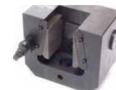
Клиновой захват ПК-50-Ш с широким раскрытием до 60 мм, 50 кН
