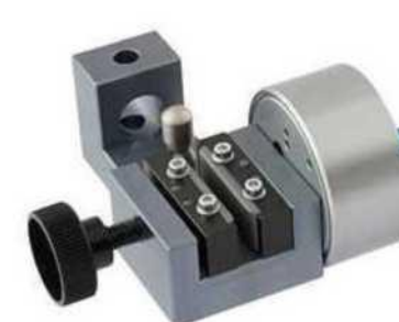
Пневмозахват тисочный ПТП-2,5 с пальцем для намотки (2,5 кН)
