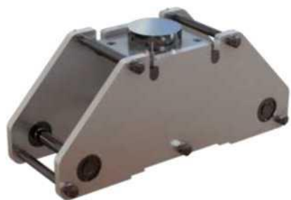
Приспособление для испытания бетонных образцов 70x70x280 мм. на растяжение при изгибе по ГОСТ 10180-90
