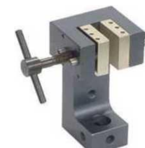
Тисочный захват ПТ-1, ПТП-1, ПТ2П-1 для пластмасс, бумаги, текстиля, алюминия, латуни (1 кН)
