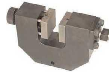
Гидравлический тисочный захват ПТГ-60 (60 кН)
