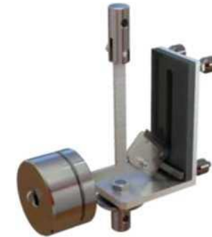
Приспособление для определения сопротивления материалов применяемых для изготовления одежды специальной и средств индивидуальной защиты рук к порезу по ГОСТ 12.4.141-99
