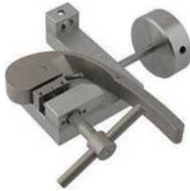
Захват «Улитка» ПУ-5 для образцов до 20 мм, 5 кН (0 3 мм)
