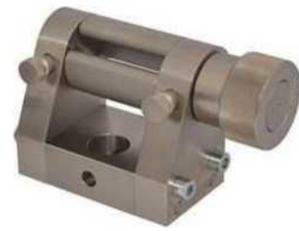
Вальцевый захват ПВ (20, 50, 100, 150 кН) для образцов 80-120 мм
