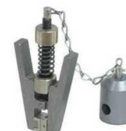
Пинцетный захват с подвижной и жесткой фиксацией ПП-0,02 (0,02 кН)
