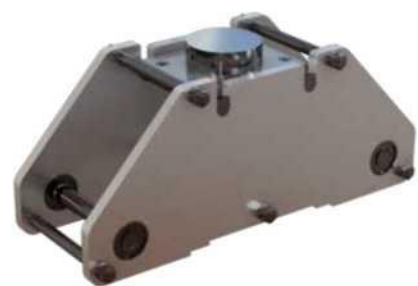
Приспособление для испытания бетонных образцов 70x70x280 мм. на растяжение при изгибе по ГОСТ 10180-90
