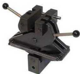
Самозажимной ножничный захват ПН-50-С, 50 кН
