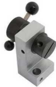
Вальцевый захват ПВ (8, 10, 50 кН) для образцов 25 мм
