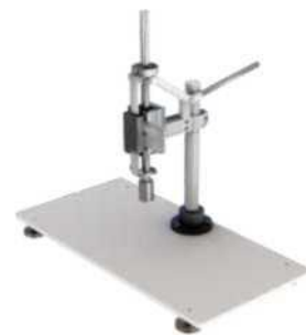
Прибор для определения общей и остаточной деформации подноски и задника обуви по ГОСТ 9135
