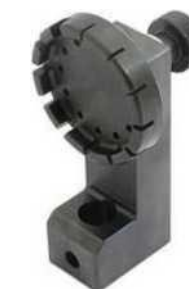
Захват для проводов с наконечниками ПЗ-50, 50 кН
