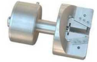
Пнеumo и гидрозахват клиновой ПКП-Т, ПКГ-Т для высоких температур (10-250 кН)
