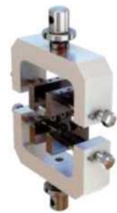
Приспособление для определения прочности клеевого и гвоздевого крепления каблука и набойки ПО-6 НКН
