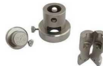
Захват с упором для цилиндрических образцов с заплечиками ПЗ-ЗОО-У
