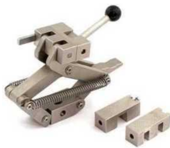
Самозажимной ножничный захват ПН-5-С, 5 кН
