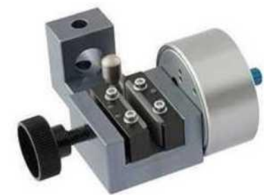
Пневмозахват тисочный ПТП-2,5 с пальцем для намотки (2,5 кН)
